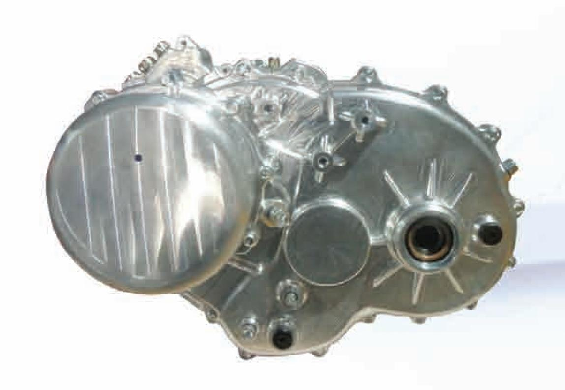
海科新能源的"电动式"飞轮混动系统—循环型动能推进系统<sup>®</sup>是新能源汽车动力系统中的世界最前沿技术,利用飞轮以机械能形式储存能量,将车辆制动的动能转化为飞轮动能,并在车辆加速时释放,提供辅助动力,以增强动力和降低能耗。
